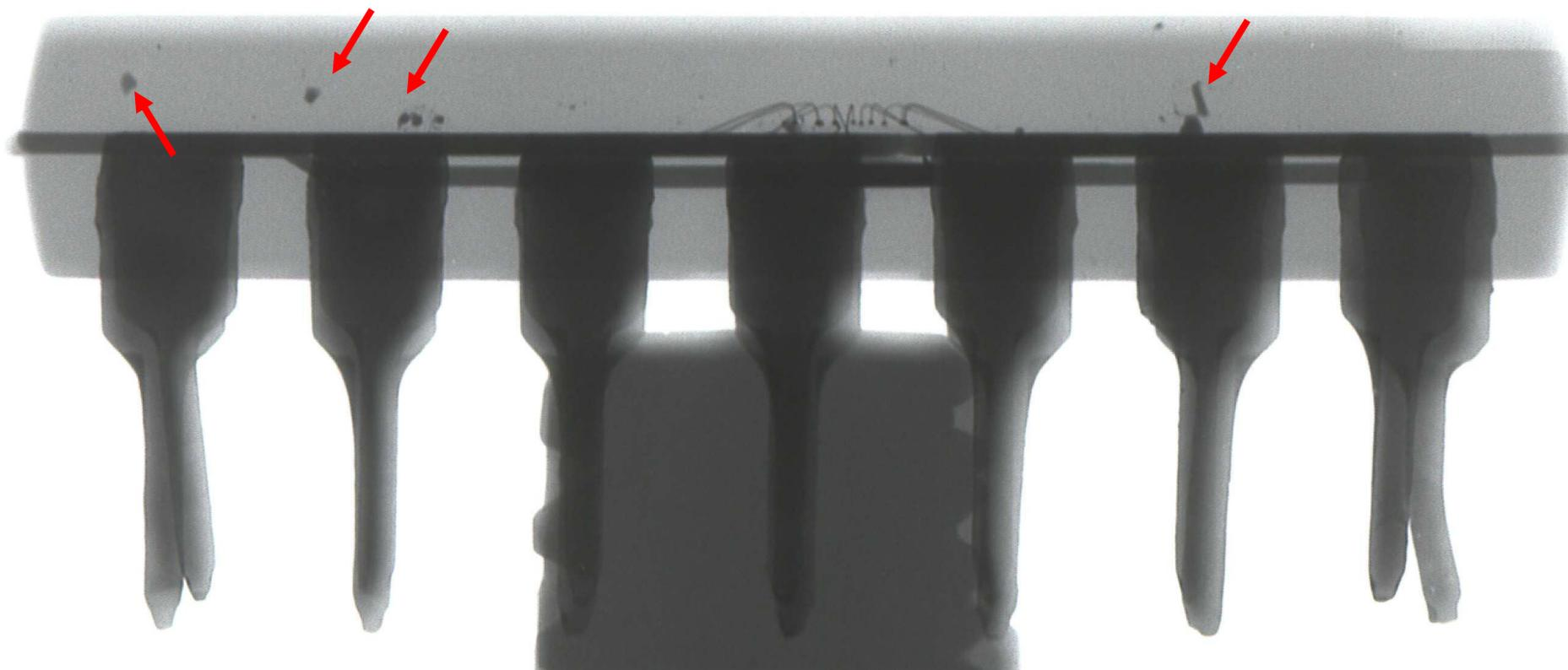
Посторонние металлические частицы в полимерном материале корпуса.
