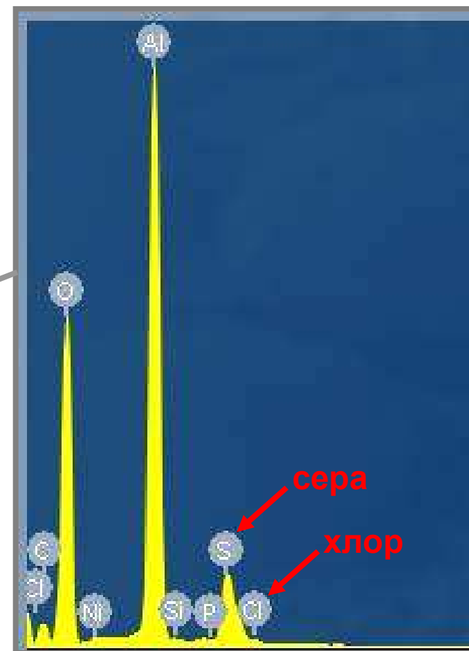
спектр элементного состава продуктов коррозии
